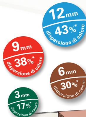
Riduzioni drastiche di perdita di calore, sono il risultato delle particolari proprietà del materiale (in relazione a un muro di mattoni di 24 cm non isolato).
